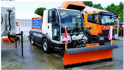
Mit der Kehrmaschine in den Winterdienst: Die Bucher Citycat 5006 bietet nach ca. 30 min Rüstzeit diese Mehrfachnutzung.
