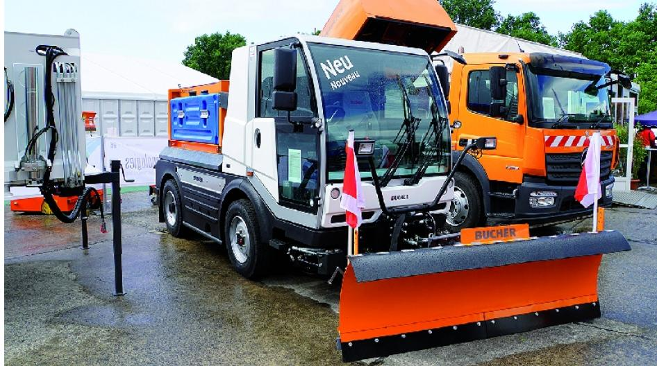
Mit der Kehrmaschine in den Winterdienst: Die Bucher Citycat 5006 bietet nach ca. 30 min Rüstzeit diese Mehrfachnutzung.
