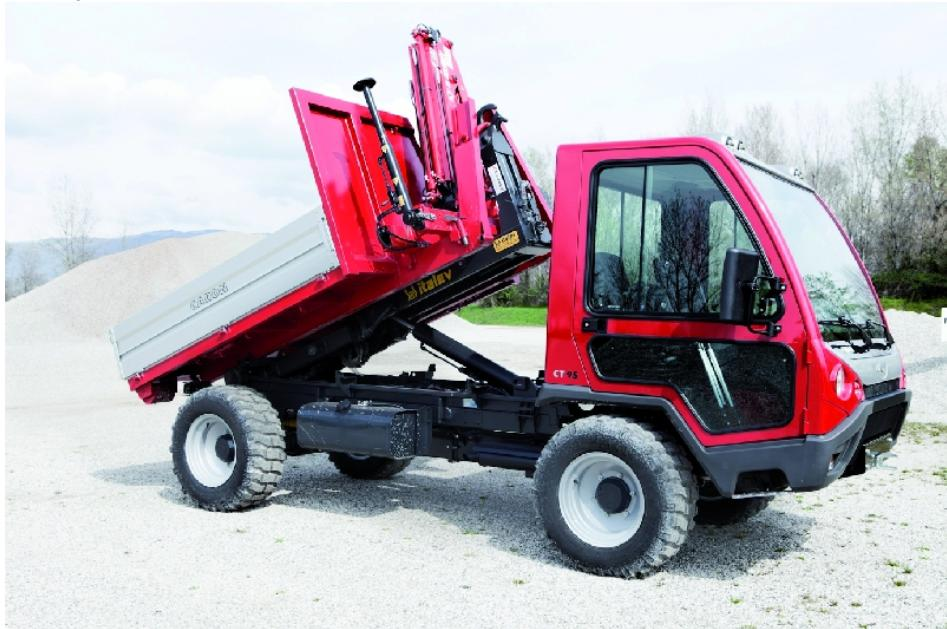
Die Baureihe CT kann mit einem zulässigen Gesamtgewicht von 10 t eine Nutzlast bis 7 t und eine Zuglast bis 14 t problemlos bewältigen.
