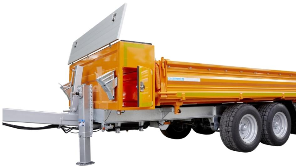
Die Option des doppelten Staukastens ist äußerst beliebt bei Kommunen. Bild.
