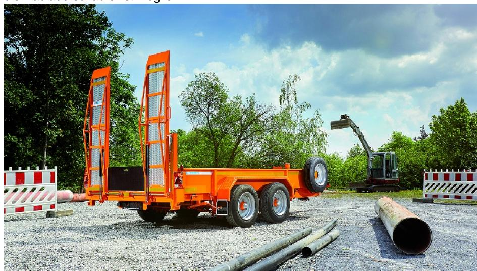
Ein Durchfahrtieflader eröffnet variable Möglichkeiten für den Maschinentransport. Bild:
