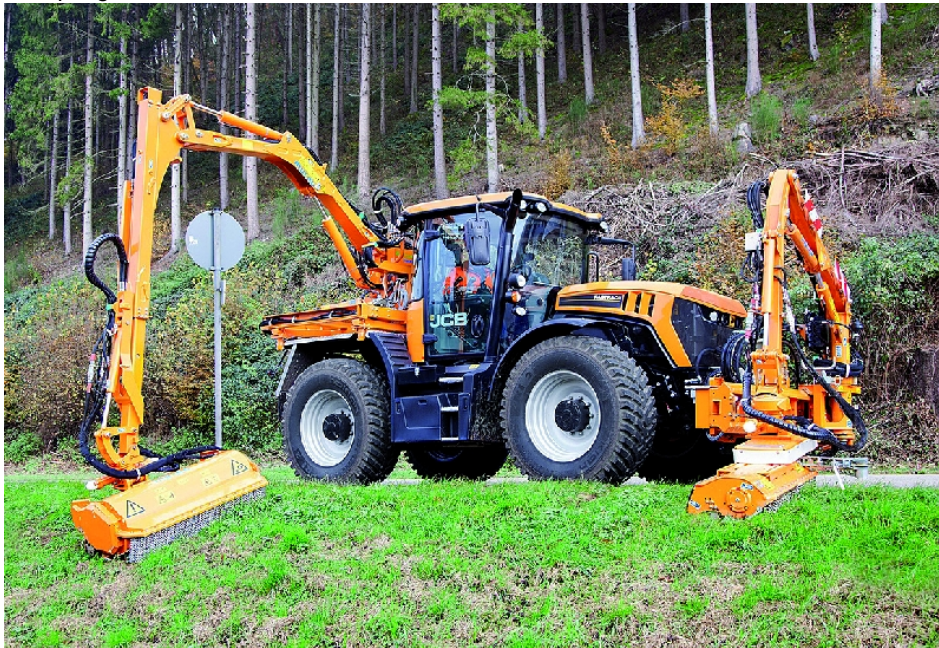
Derastrac 4000 von JCB mit Mulag-Mähkombination.
