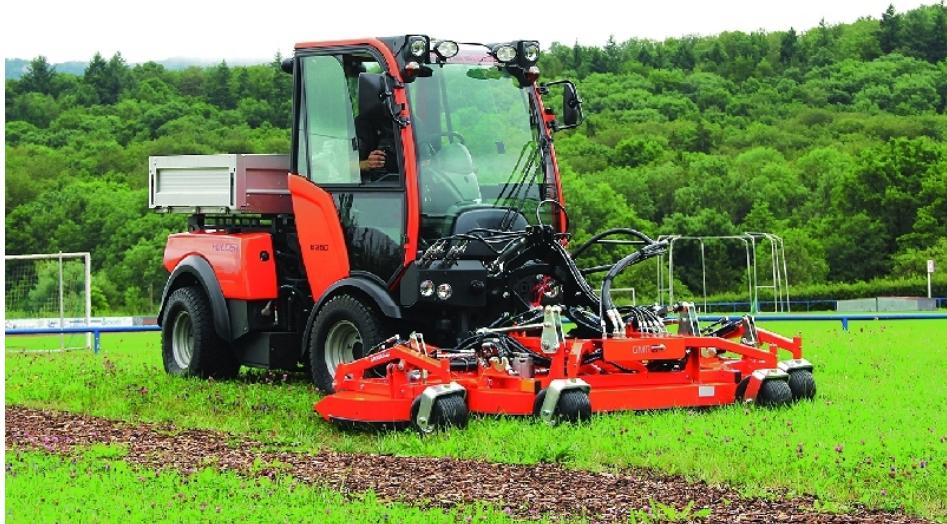
Antrieb per Radnabenmotor: Power Drive beim B 55 von Holder.
