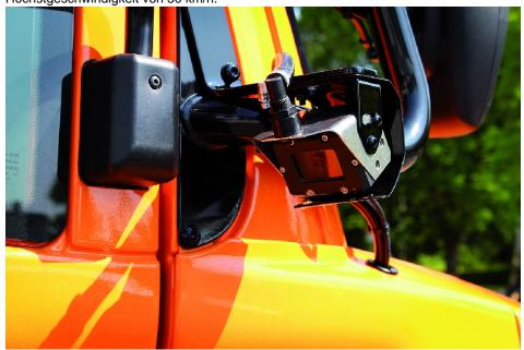
Hilfe für den Fahrer, Schutz für Radler: Abbiegekamerasystem am Unimog.
