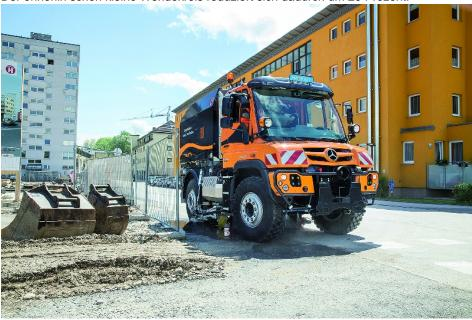
Kehrmaschinen auf dem Fahrgestell erhalten jetzt mehr Leistung aus dem Unimog-Motor.
