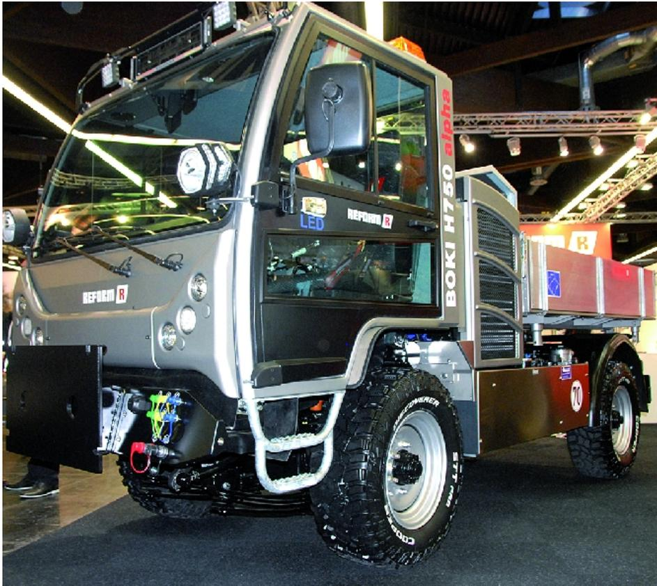
Mehr Nutzlast und ein neuer Fahrtrieb: Reform hat mit dem Typ H750 alpha den Boki weiter entwickelt.
