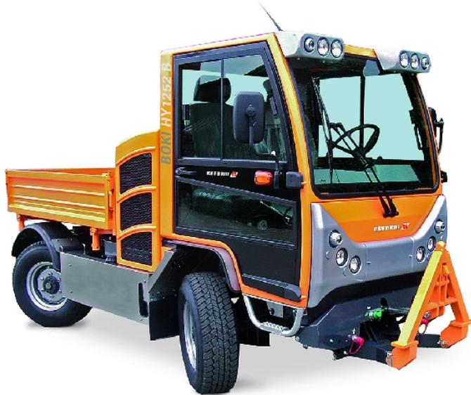
Im Kern ein Bokimobil, unter der Regie von Reform aber weiterentwickelt: Boki 1152, auch mit hydrostatischem Antrieb lieferbar.
