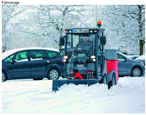
Hako baut sein Programm der knickgelenkten Geräteträger weiter aus. Der neue Citymaster 600 ersetzt dabei vollumfänglich die Anwendungen der Hako-Kompakttraktoren.
