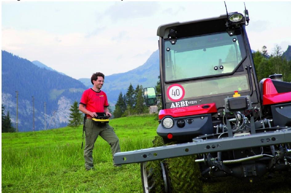
Wenn es gefährlich wird, hilft sicherer Abstand: Der Terratrac arbeitet auch per Fernbedienung oder ganz autonom.
