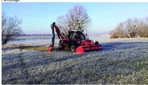
Jetzt schon aus vier Typen besteht die Grip-Baureihe von Sauerburger – hier der neue Grip 4-110 mit hydraulischer Allradlenkung.
