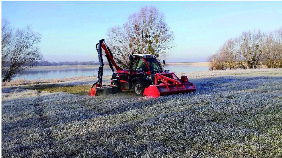
Jetzt schon aus vier Typen besteht die Grip-Baureihe von Sauerburger – hier der neue Grip 4-110 mit hydraulischer Allradlenkung.
