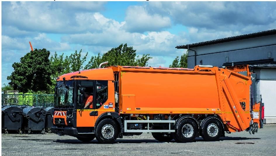
Das Müllsammelfahrzeug Renault Trucks D Access besticht mit einer effektiven Breite von nur 2300 mm und einem sehr kurzen vorderen Rahmenüberhang.
