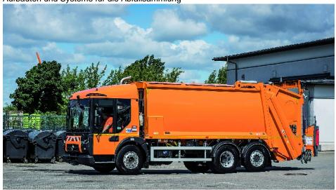
Das Müllsammelfahrzeug Renault Trucks D Access besticht mit einer efektiven Breite von nur 2300 mm und einem sehr kurzen vorderen Rahmenüberhang.
