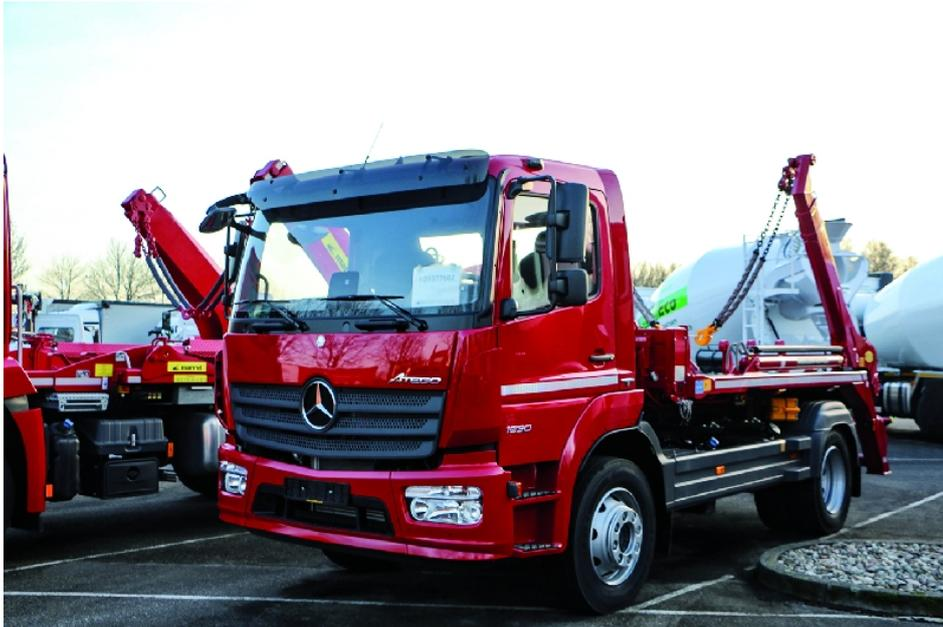
Das Fahrzeug macht den neuen Atego zum Maßstab im kommunalen Dienst. Der Reihensechszylinder OM 470 mit 10,7 l Hubraum ist der kompakteste unter den Heavy-Duty-Motoren von Mercedes-Benz.
