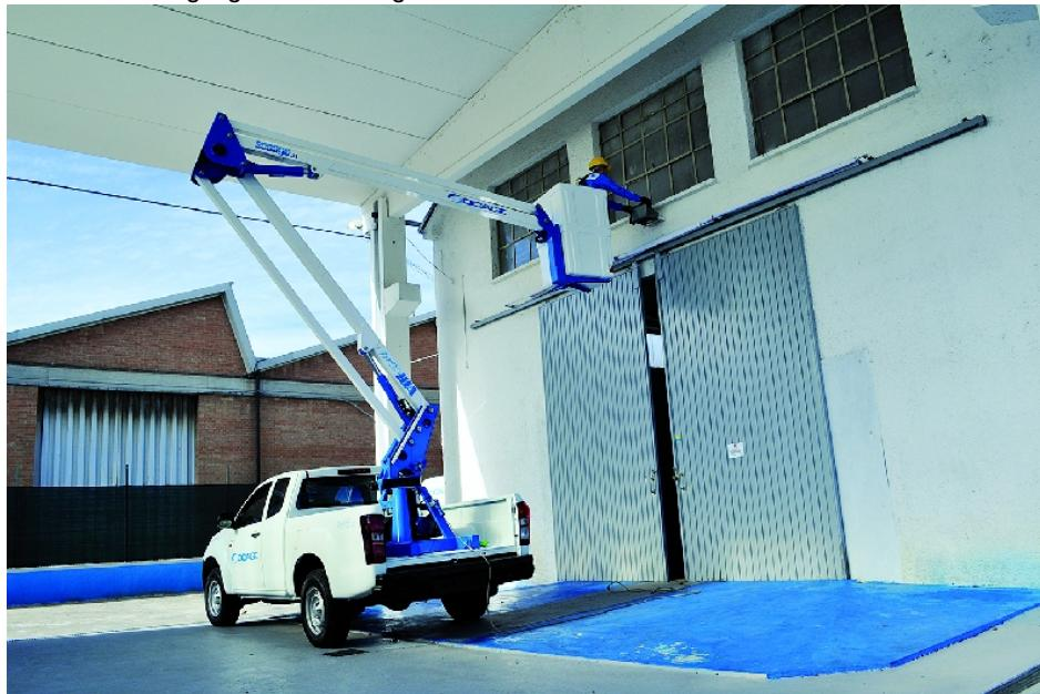
Das Arbeitsdiagramm für die Pick-up-Modelle reicht bis zu beachtlichen 16 m Höhe und 8 m seitliche Reichweite (Kunze).
