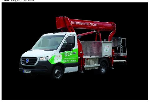
$100\ \%$  elektrisch und  $100\ \%$  flexibel – der neue Ruthmann Steiger Ampero TBR 250 E auf einer E-Sprinter-Umrüstung.
