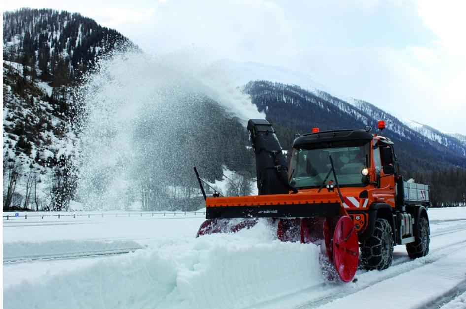
Die FS-HP-Anbau-Schneefrässchleudern decken durch unterschiedliche Räumleistungen und Räumbreiten eine große Palette von Anforderungen ab. Die neue High-Performance-Variante tritt als Nachfolge der FS an. Durch die Überarbeitungen der Fräswendel und des Schleuderrades wurde eine Leistungssteigerung von ca. 25 % erreicht (Aebi Schmidt).
