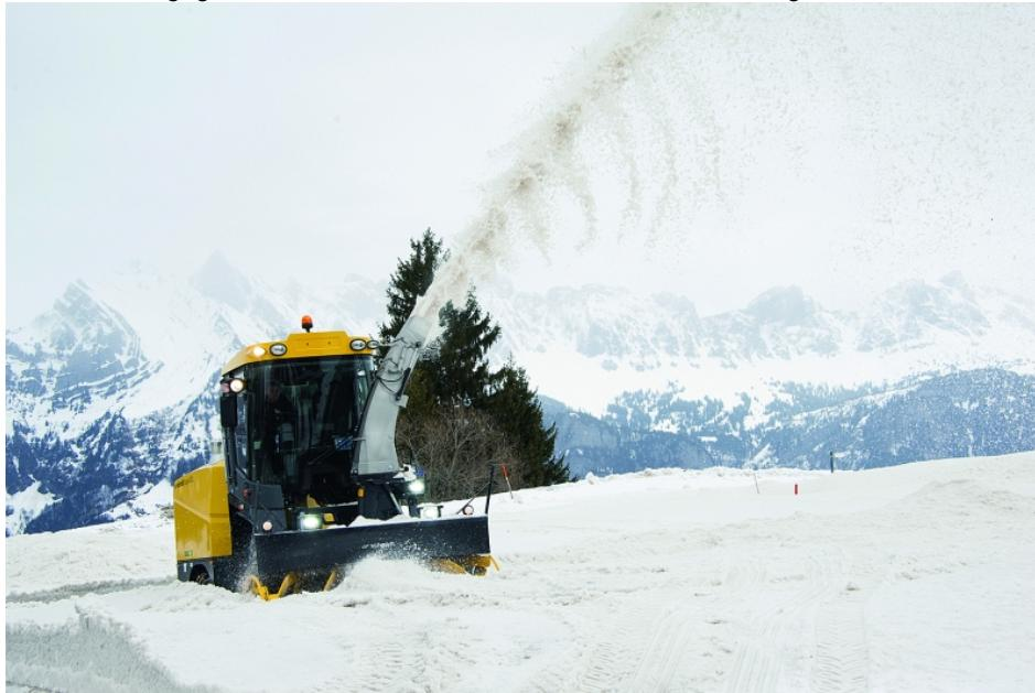
Die selbsfahrenden Schneefrässchleudern der Supra-Baureihe sind wahre Kraftpakete. Die Supra 4002 kann bis zu 3500 t pro Stunde räumen und wirft den geräumten Schnee
