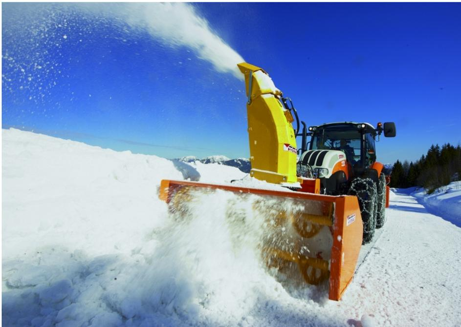
Zwei Zuführschnecken zerteilen den Schnee und fördern ihn zur Auswurf-turbine, durch die er kraftvoll hinausgeschleudert wird (HYDRAC).
