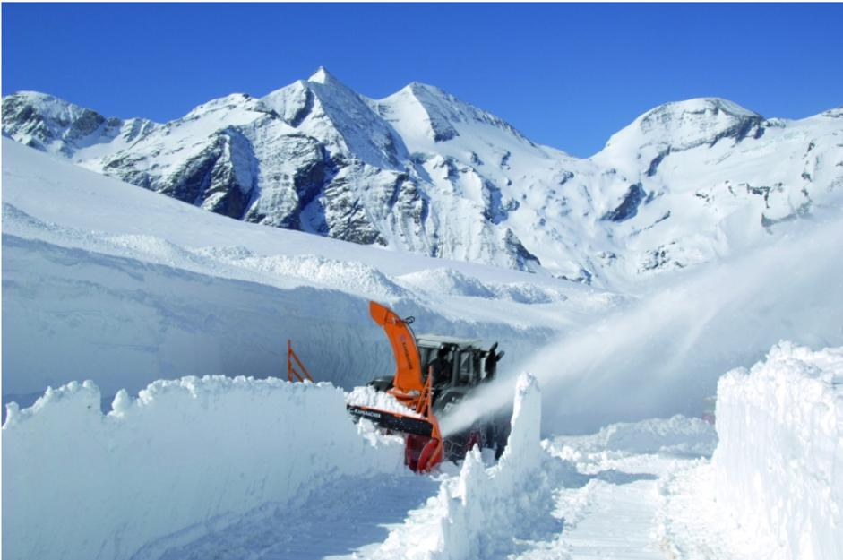
Die neue Generation der KFS-1150-Reihe besteht u. a. durch ein vergrößertes und optimiertes Schleuderrad (Kahlbacher).
