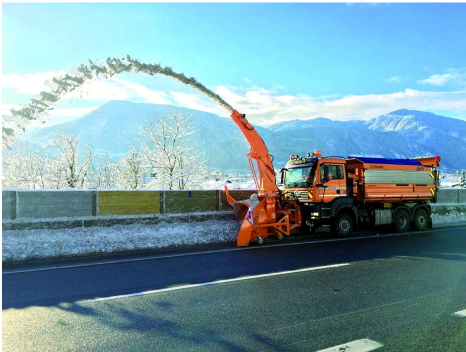
Eine Kahlbacher Seiten-Schneefrässchleuder KSL 130 mit hydraulischem Fahr- und Geräteantrieb im Einsatz.
