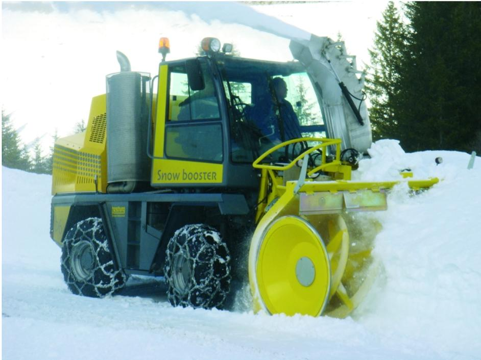
Der Boschung Snowbooster B6 ist eine leistungsstarke Schneefräse für den intensiven Winterdienst. Mit drei verfügbaren Arbeitsbreiten von 2100, 2300 und 2500 mm wird eine maximale Räumleistung von ca. 3500 t/h erreicht.
