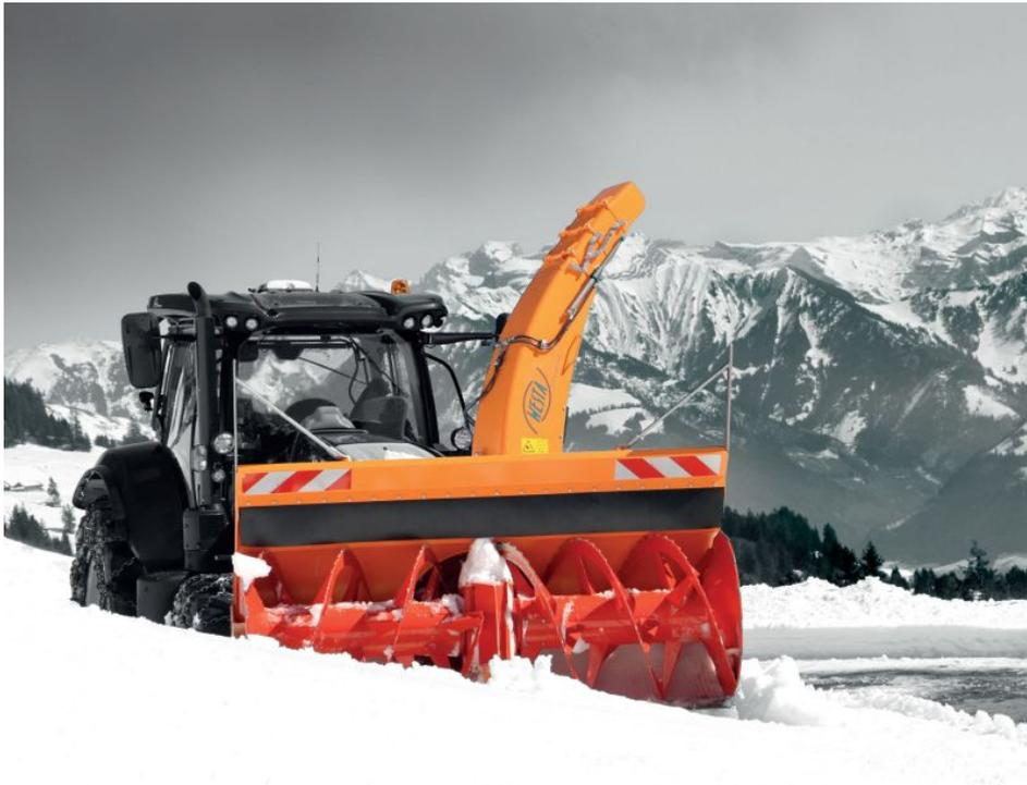
Die Type »900« für Trägerfahrzeuge von 80 bis 140 PS steht in Arbeitsbreiten zwischen 1,6 und 2,5 m zur Verfügung (Bild: Westa).
