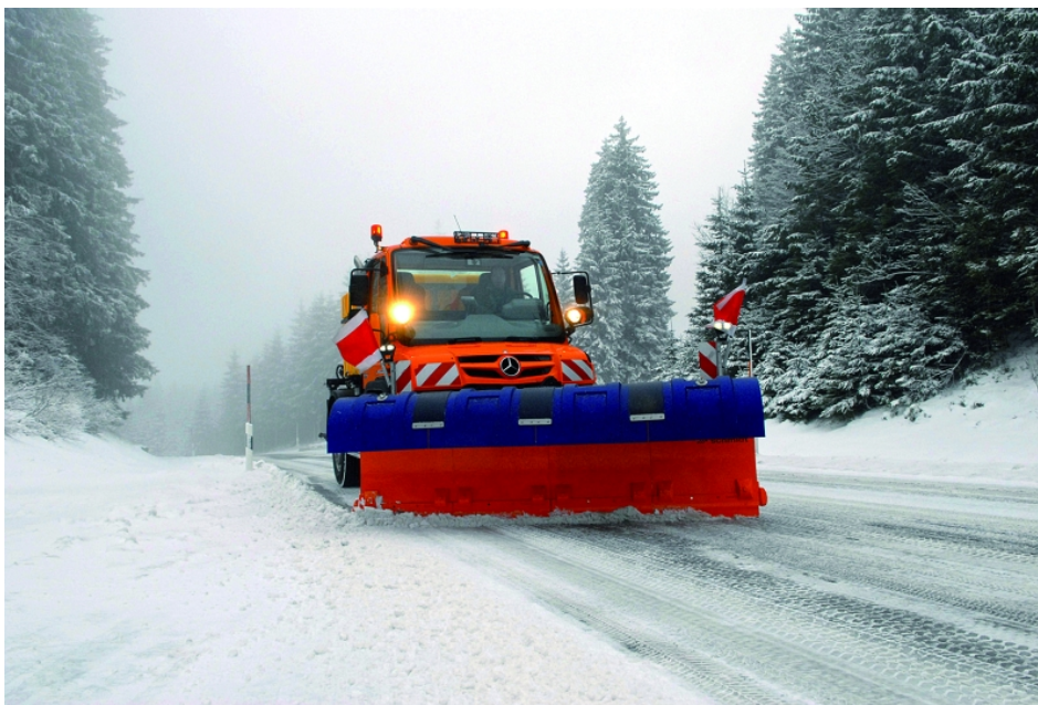
Cirron-Schneepflug, angebaut an einen schweren Unimog U500. Die Cirron-Pflüge verfügen über ein patentiertes Federlenksystem (Aebi Schmidt).
