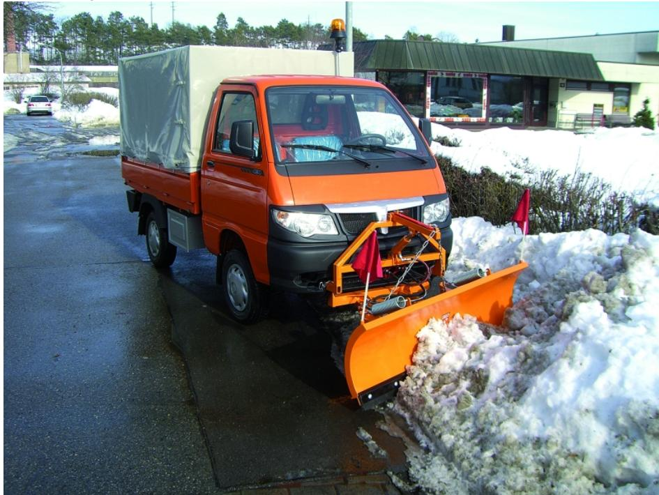
Für kleinere Fahrzeuge mit geringer Vorderachslast hat Bertsche die UL-Schneepflüge im Programm. Diese sind besonders leicht und benötigen durch ihre Bauart eine niedrigere Schubleistung.
