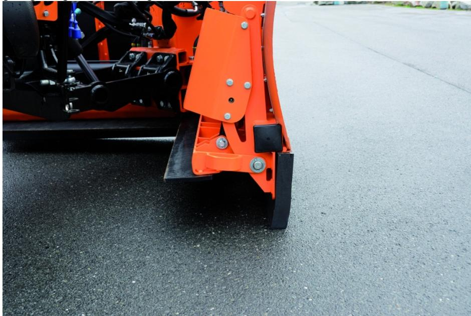
Hydraulisch steuerbares Doppelschürleisten-System. Je nach Fahrbahnoberfläche kommt die zweite Schürfleiste zum Einsatz (Bucher Municipal).
