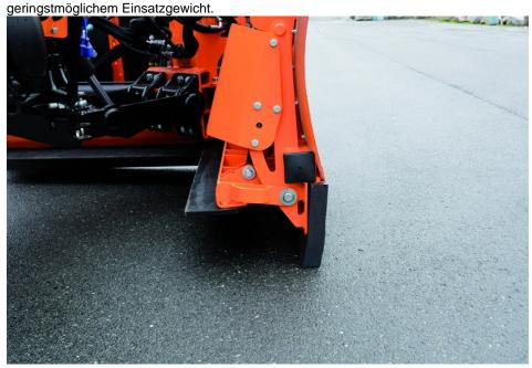
Hydraulisch steuerbares Doppelschürleisten-System. Je nach Fahrbahnoberfläche kommt die zweite Schürfleiste zum Einsatz (Bucher Municipal).
