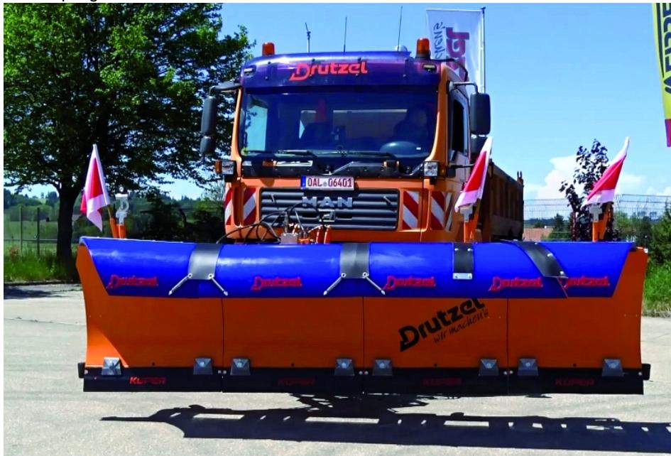
Ein Klappscharschneepflug von Drutzel. Die Arbeitsbreite kann durch das Einklappen einer Pflugschar (auch während der Fahrt) von 4,3 auf 3,3 m reduziert werden.
