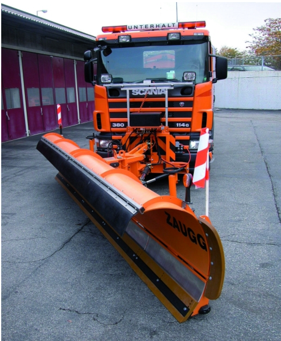
Ein Zaugg Lkw-Schneepflug mit maximal eingestelltem Schwenkwinkel.
