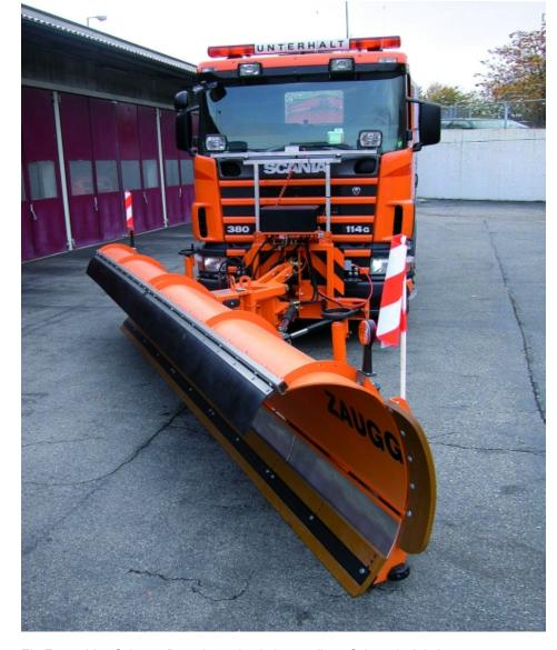
Ein Zaugg Lkw-Schneepflug mit maximal eingestelltem Schwenkwinkel.
