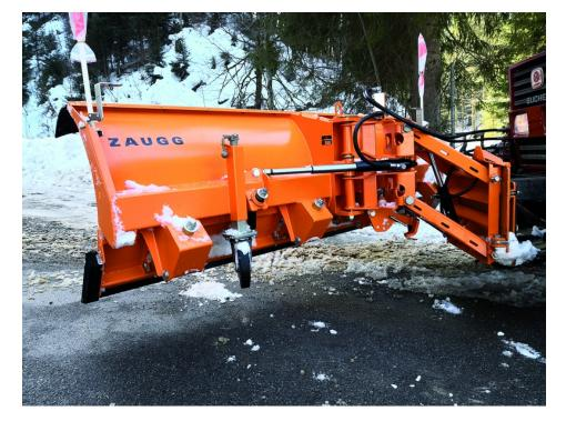
Der neue Zaugg-Schneepflug G 16 besticht durch sein geringes Gewicht und mit dem patentierten Überfahrmechanismus.
