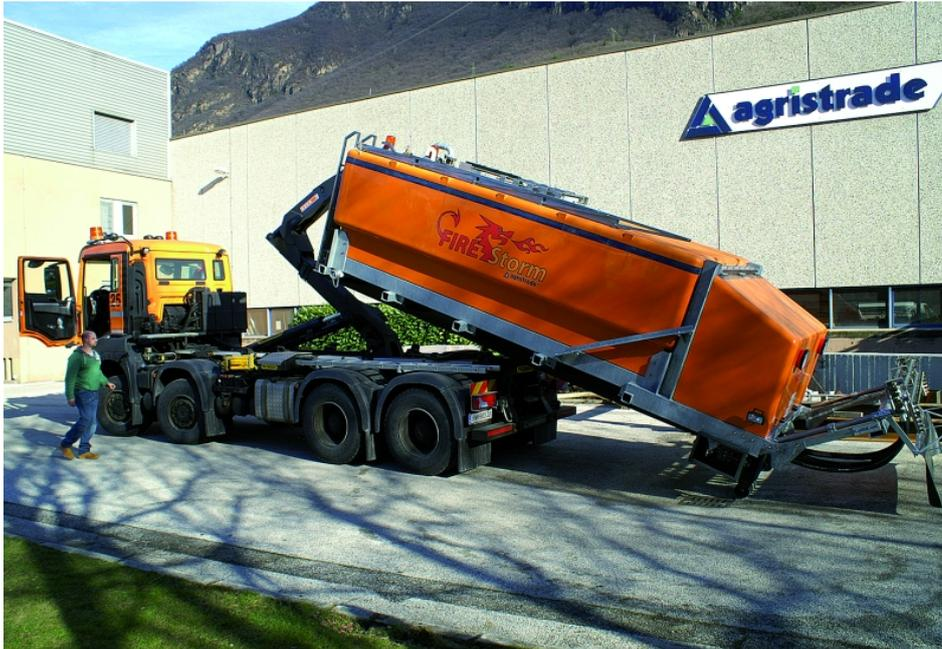
Dieser Agristrade Firestorm, auf Hackenrahmen und mit 12.000 l Solebehälter, ist für die Asfinag auf der Autobahn A21 bei Wien im Einsatz. Stationiert ist er bei der Autobahnmeisterei in Alland.
