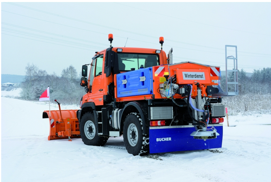
Bucher-Streuautomat Yeti 1600 auf Unimog 218 mit Ramox-Schneepflug.
