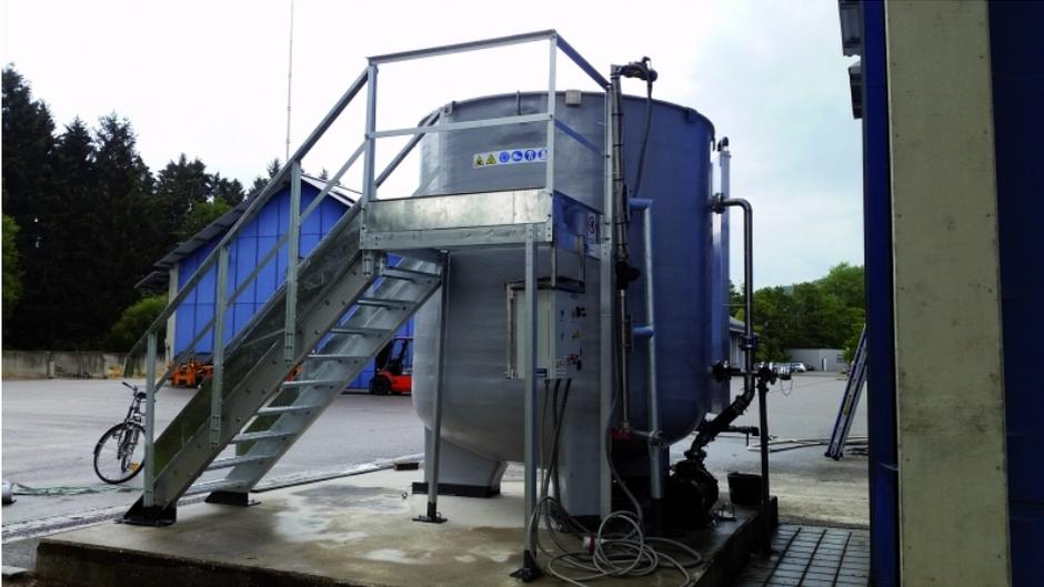
Der Soleerzeuger Speed Brine für die schnelle Vorbereitung von NaCl- und CaCl<sub>2</sub>-Sole. Leistungsfähigkeit: 10.000 l Sole in 30 Minuten. Staatliches Bauamt Amberg-Sulzbach, Straßenmeisterei Nabburg (Agristrade).
