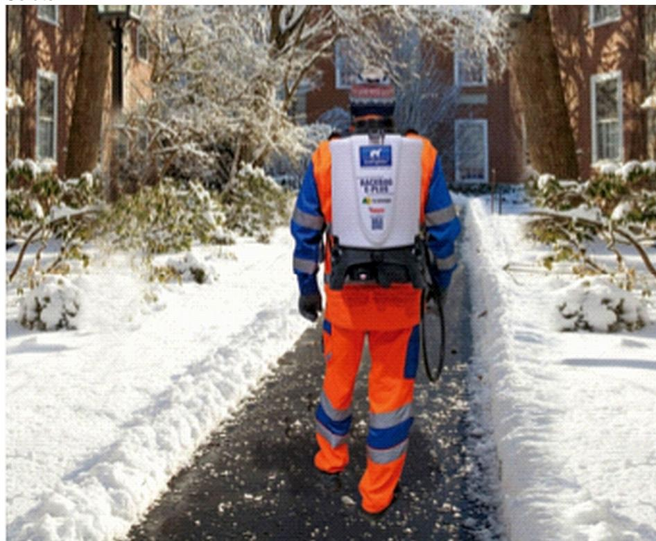
Der IceFighter BackBag E ist das ideale Ausbringgerät für Salzsole in elektrischer Ausführung. Mit dem Gerät lassen sich Eis und Glätte von Treppen, Gehsteigen und Einfahrten effizient und umweltschonend entfernen (Birchmeier Sprühtechnik).
