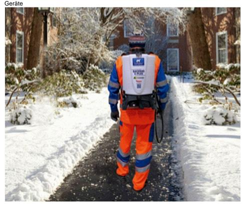
Der IceFighter BackBag E ist das ideale Ausbringgerät für Salzsole in elektrischer Ausführung. Mit dem Gerät lassen sich Eis und Glätte von Treppen, Gehsteigen und Einfahrten effizient und umweltschonend entfernen (Birchmeier Sprühtechnik).
