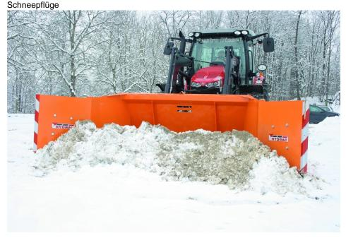
Eine Schaufel – viele Einsatzmöglichkeiten. Mit der Winterschaufel von Hydrac kann Schnee verladen wie auch mit ausgeschwenkten Seitenklappen geschoben werden.
