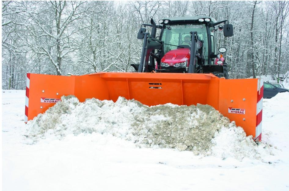
Eine Schaufel – viele Einsatzmöglichkeiten. Mit der Winterschaufel von Hydrac kann Schnee verladen wie auch mit ausgeschwenkten Seitenklappen geschoben werden.
