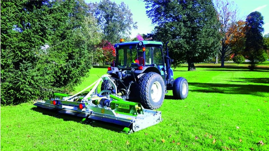
Klappbarer Großflächen-Sichelmäher mit Dreipunktaufnahme (Major). In Deutschland wird der Hersteller aus Irland über die Firma Krengel vertreten.
