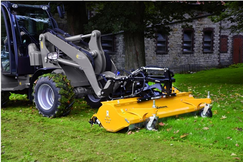
Laderaufnahme MU-Connect 200 mit virtuellem Zugpunkt. Das Gerät wird gezogen und kann der Bodenkontur optimal folgen (Müthing).
