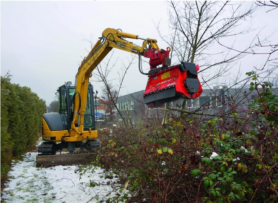
Mit der Mulchfräse für den Baggeranbau lassen leicht überwucherte Flächen einfacher erreichen (Bild: Prinoth).
