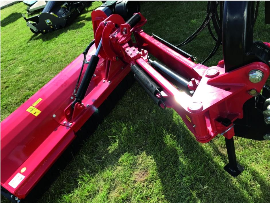
Agritec hat zwei weitere federgestützte Schutzeinrichtungen für seinen Seitenausleger verbaut, um diesen im Einsatz noch besser vor Beschädigungen zu schützen. Ein Federgelenk am Anbaukopf lässt ein Ausklinken des Mähkopfes um ca. 15° zu.
