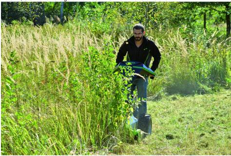
Neu bei Etesia: der Attila AH75 Gestrüppmäher mit 75 cm Schnittbreite und einem 7,3 kW starken Honda GXV390-OHV-Motor.
