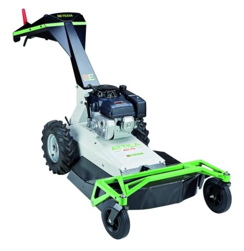
Der Mäher besitzt ein hydraulisches Getriebe und eine Differenzialsperre. Zudem hat das Geräte auch einen Rückwärtsgang.
