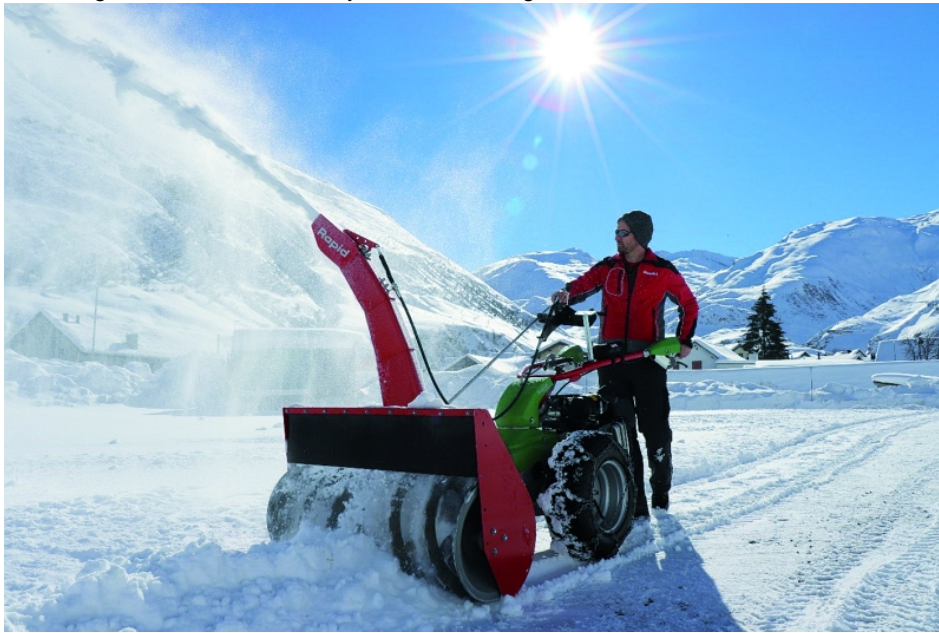
Ein Rapid Varea 231 Geräteträger mit einer 105 cm breiten Schneefräse.
