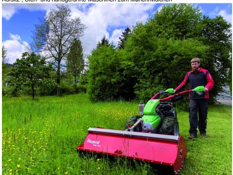
Ein 23 PS starker Rapid Varea 5231 mit drehbarem Holm und angebautem Schlegelmulcher.
