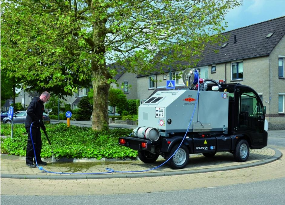
Das Heißwassergerät MCB-E wird auf einen Elektrotransporter aufgebaut. Es entfernt das Unkraut leise und umweltschonend.
