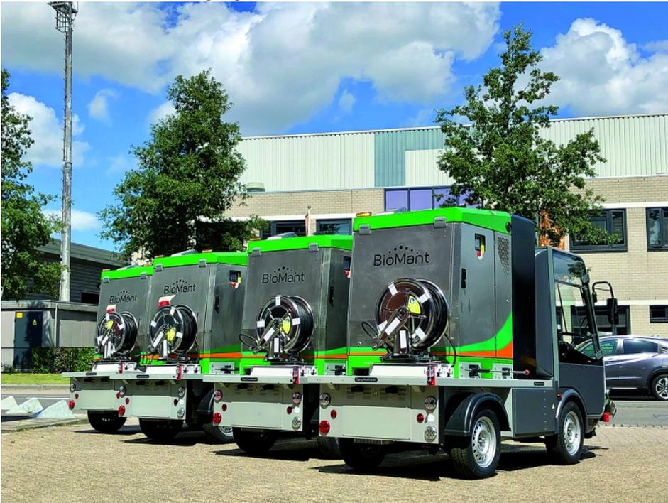
Heißwassersystem, BioMant ONE auf Elektroträgerfahrzeugen des Herstellers Spijkstaal (Mantis).
