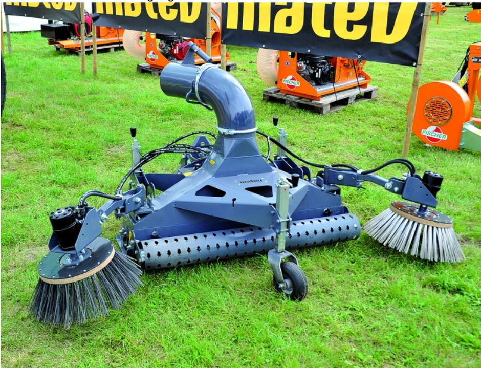
Neu bei Matev: die Multifunktionssaugdüse MRM-H 120. Die Seitenbesen zur Laub- oder Wildkrautbeseitigung werden werkzeuglos angebracht.
