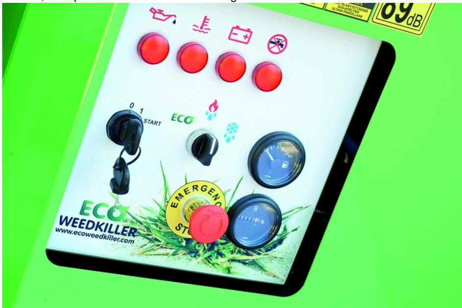
Drei Modi sind verfügbar: Unkrautbekämpfung, Reinigung/Desinfektion mit Hochdruck, Bewässerung.
