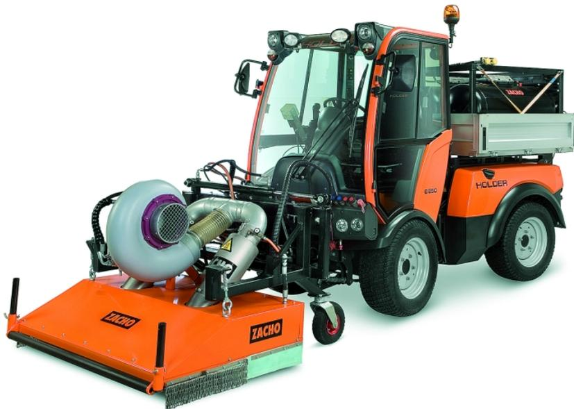
Zacho Unkrautbeseitiger für Autogas-LPG als Anbaugerät an einem Holder X45. Das Gerät arbeitet mit Heißluft (Stavermann).
