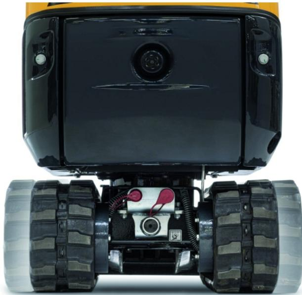
Der Unterwagen des HX10A lässt sich bei größerer seitlicher Last in der Breite ausfahren.
