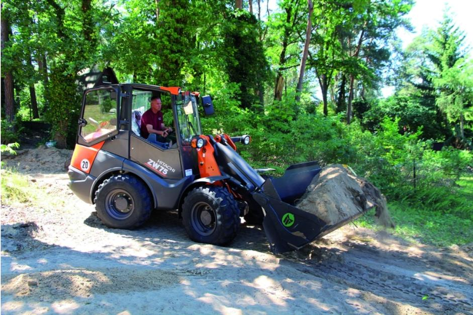
Sichere Fahrt auch mit voller Schaufel und im abschüssigen Gelände – kein Problem für den Kompaktradlader Hitachi ZW75 (Kiesel).
