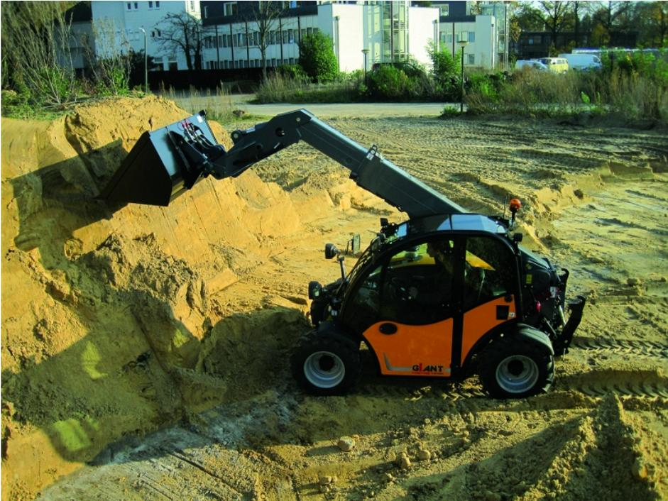
Der G4548 Tendo kann stapeln, Material aufnehmen oder ausschütten und ist mit verschiedenen Anbaugeräten flexibel einsetzbar (Kiesel).
