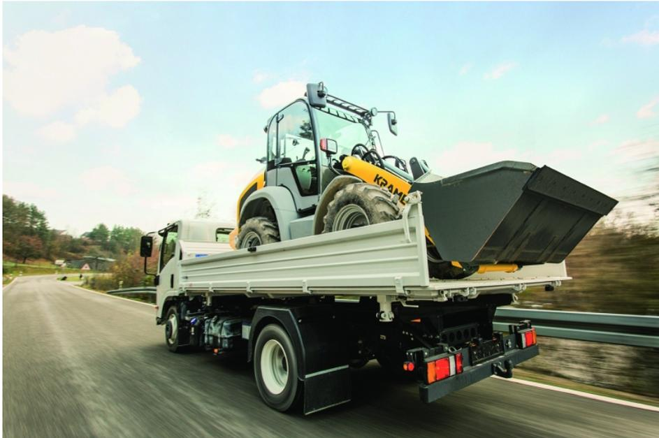
Der Kramer Radlader 5050 hat ein geringes Eigengewicht mit bis zu 2,65 t. Zusatzgewichte (»Smart Ballast«) können am Heck hinzugefügt werden. Diese Anpassungsfähigkeit gewährleistet einen Transport auf einem 3,5-t-Anhänger.
