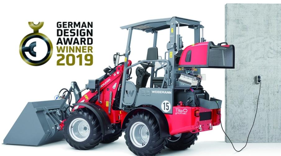
Der eHoftrac 1160 ist ein vollelektrisch angetriebener Lader, der geräuscharm und ohne Abgase in öffentlichen Anlagen eingesetzt werden kann.
