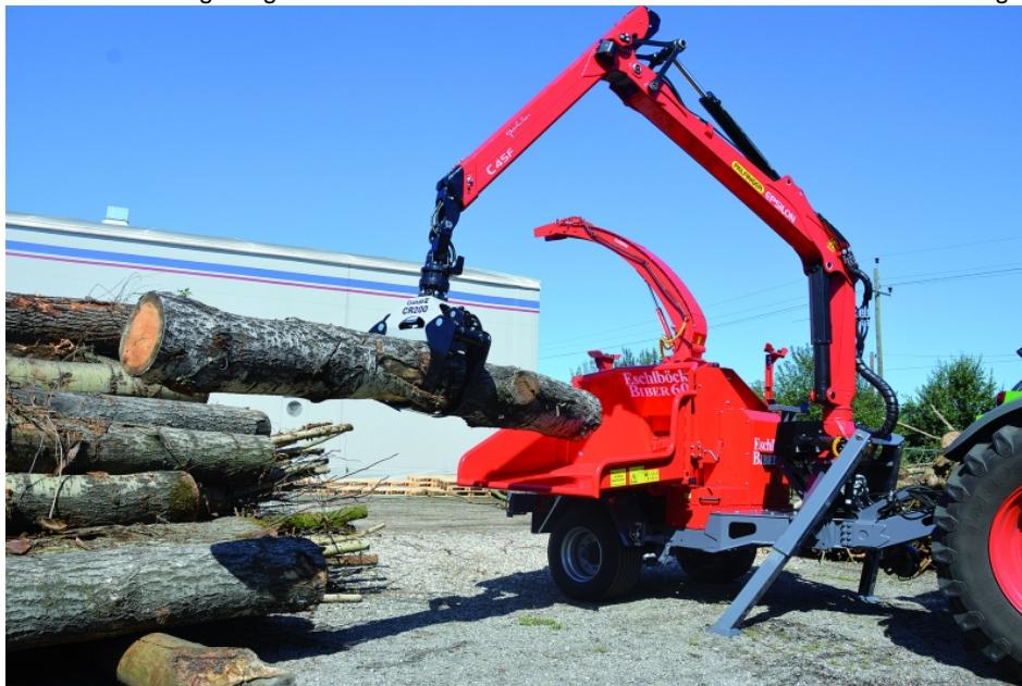
Für die Biomasseverkleinerung ist der Biber 60 die neue Einsteigermaschine.
