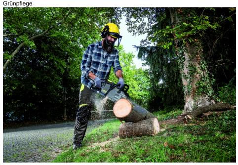
Ganz ohne Abgase und dank reduzierter Vibrationen sind die Akku-Geräte von Kärcher besonders anwenderfreundlich. Hier die neue Kettensäge mit 4,8 kg Gewicht und 400 mm langem Sägeblatt.
