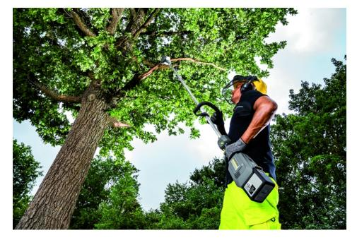
Das Multi-Tool mit Sägen-Aufsatz zum Entlasten. Die Akkus integriert Kärcher generell in die Geräte.
