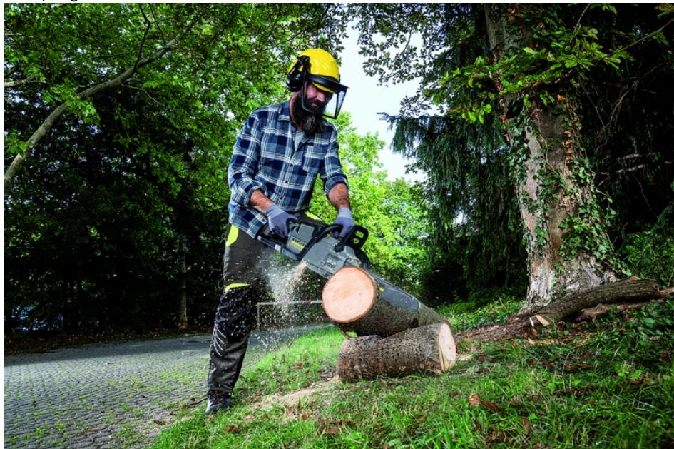
Ganz ohne Abgase und dank reduzierter Vibratoren sind die Akku-Geräte von Kärcher besonders anwenderfreundlich. Hier die neue Kettensäge mit 4,8 kg Gewicht und 400 mm langem Sägeblatt.
