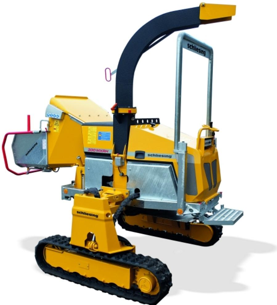
Schliesing Holzzerkleinerer auf hydraulisch verstellbarem Raupenfahrwerk zum Hangausgleich (bis zu 30° Steigung möglich).
