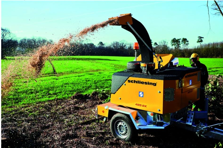
Neuer Schliesing Mittelklasse-Holzzerkleinerer 425 EX/TX mit 270° verdrehbarem Hackwerk und wassergekühltem Dieselmotor von Hatz.
