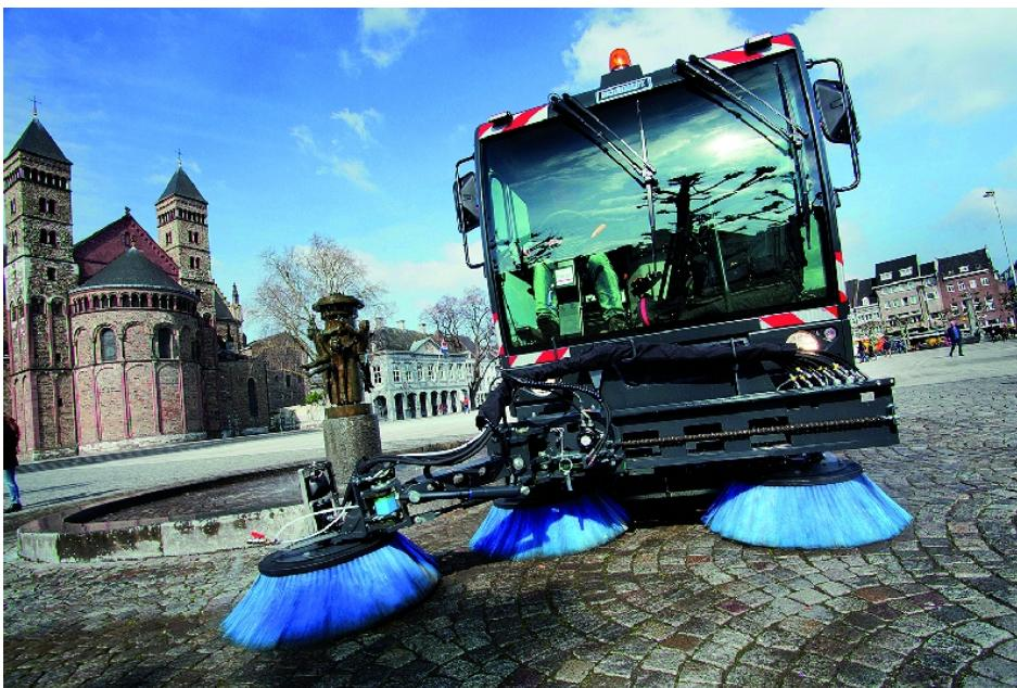
Die Tellerbesen arbeiten im Einsatz nicht einfach nur in der Schwimmstellung, sondern lassen sich überdies mit einem unabhängigen Bodenaufagedruck hydraulisch steuern.
