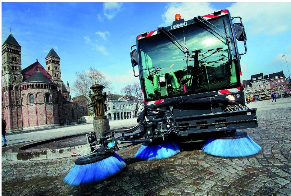
Die Tellerbesen arbeiten im Einsatz nicht einfach nur in der Schwimmstellung, sondern lassen sich überdies mit einem unabhängigen Bodenauflagedruck hydraulisch steuern.
