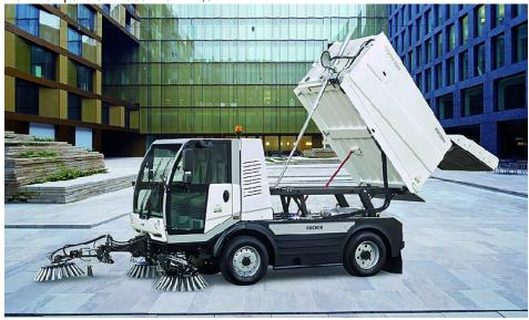
Kehrmaschine CityCat 5006 mit 118 kW starkem Dieselmotor in Euro 6: Die modular auf einem Lkw-Chassis basierende Reinigungsmaschine (Behältervolumen 4,3 m³ netto) hat eine enorme Saugleistung und Reichweite.
