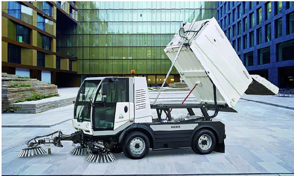
Kehrmaschine CityCat 5006 mit 118 kW starkem Dieselmotor in Euro 6: Die modular auf einem Lkw-Chassis basierende Reinigungsmaschine (Behältervolumen 4,3 m<sup>3</sup> netto) hat eine enorme Saugleistung und Reichweite.
