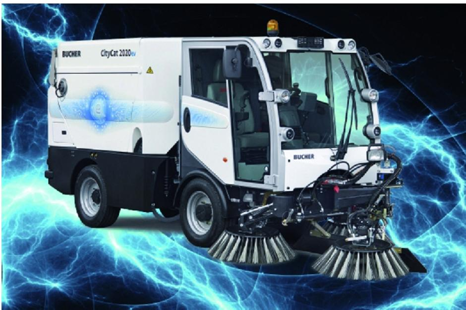
Elektrisch angetriebene Kompaktkehrmaschine 2020ev von Bucher Municipal. Die Batterie liefert Energie für acht Stunden Kehreinsatz.
